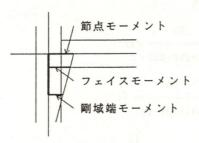
図 4.22 R C 造柱断面計算
