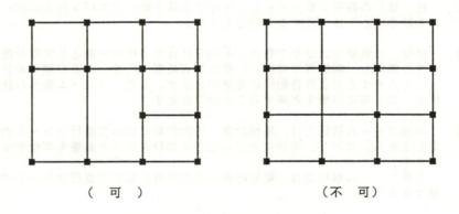
図 3.6 柱抜け例
