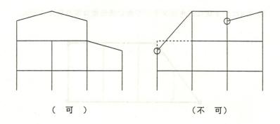
図 3.2 傾斜ばりの例
