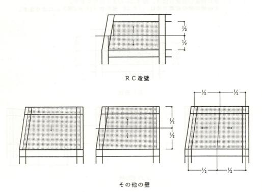
図 4.27 壁荷重の伝達方法
