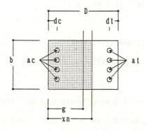
図 4.23 柱主筋計算
