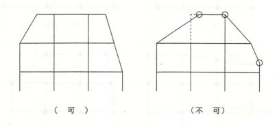
図 3.1 斜柱の例
