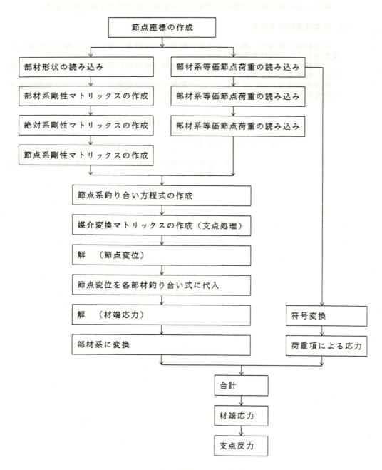
図 4.16 変形法計算方法
