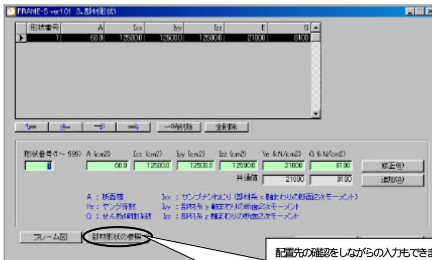
使用する部材の断面性能を直接入力します。999
